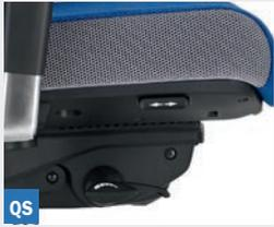
**Syncro-Quickshift®:** mécanisme synchrone avec réglage rapide de la tension, mouvement synchrone verrouillable en 4 positions. Réglage de l'inclinaison de l'assise en trois positions (-1°/-3,5°/-6°) et de la profondeur d'assise (6 cm) par assise coulissante de série
