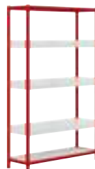
Etagère d'une très grande stabilité. Assemblage facile et rapide. Tablettes renforcées réglables montées sur crémaillère par pas de 50 mm. Piètement en tube 30/30 ép. 1,5 mm ; cadre soudé en tube 40/20 ép. 1,5 mm ; revêtu époxy. Embouts non tachants et non marquants (polyéthylène). L111xP36xH181,5 cm.
